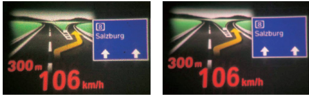
Bild mit starkem Specklen (links) vs. verbesserte Möglichkeiten heute (rechts); Patent: LBO
