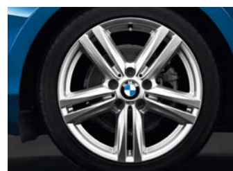
18" Leichtmetallräder Sternspeiche 386 M 7½Jx18 mit Bereifung 225/40 vorn, 8Jx18 mit Bereifung 245/35 hinten
