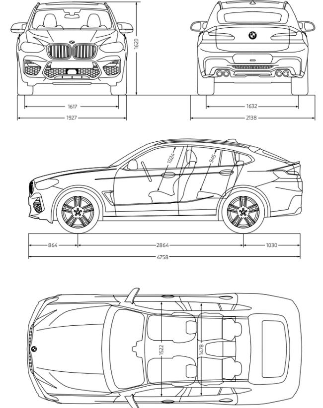
Alle Maßangaben der technischen Zeichnung in Millimeter. Angaben zu Fahrleistung, Verbrauch und CO<sub>2</sub>-Emissionen gelten für Fahrzeuge mit Seriengetriebe. Werte in [ ] gelten für Fahrzeuge mit Steptronic Getriebe.
