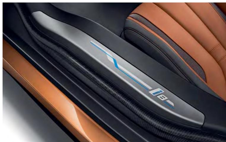
Lackierte Einstiegsleisten in Amido metallic und gelasertes Schriftzug mit Akzent in BMW i Blau.
