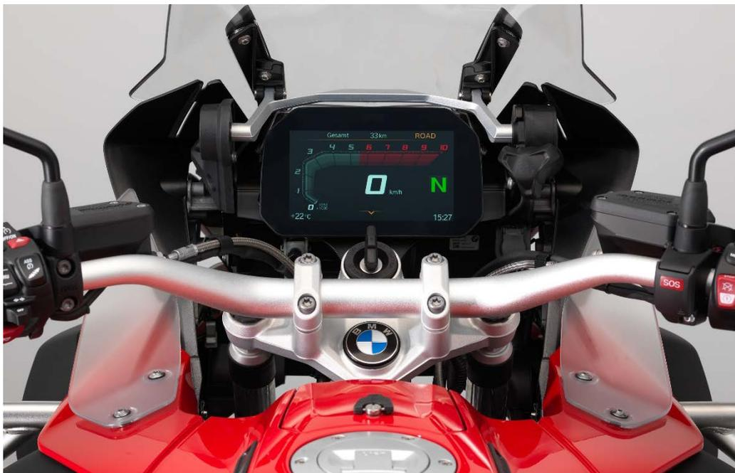
**München.** Schnelle und klare Informationen für den Fahrer bei geringstmöglicher Ablenkung vom Verkehrsgeschehen durch ein einzigartiges Bedienkonzept – dies ermöglicht die neue Sonderausstattung Connectivity von BMW Motorrad, bei der die Instrumentenkombination nun in Form eines hochwertigen, 6,5 Zoll großen Vollfarb-TFT-Displays dargestellt wird. ¶
