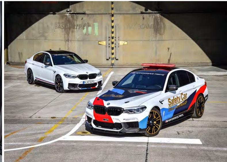
Komplettiert wurde die Verwandlung des BMW M5 in ein MotoGP Safety Car durch den Einbau spezieller Racing-Features und der notwendigen Sicherheitseinrichtungen. Beim Frontsplitter handelt es sich um einen eigens für das BMW M5 MotoGP Safety Car entwickelten Prototyp. Die Motorhauben-Verschlüsse stammen direkt aus dem Rennsport. Die Schalensitze aus dem BMW M4 GTS garantieren den Insassen die nötige Kombination aus Komfort und höchster Sicherheit im Einsatz auf der Rennstrecke.
