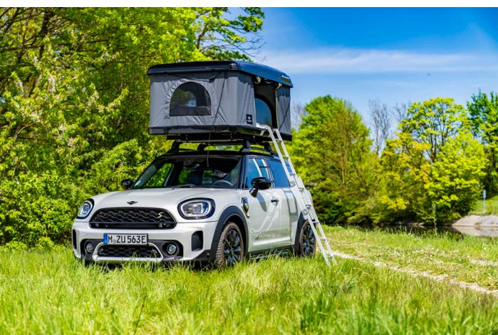
Aufstellen lässt sich die Unterkunft in luftiger Höhe innerhalb weniger Sekunden. Nach dem Lösen der Sicherheitsverschlüsse am Gehäuse hebt sich der Zeltaufbau mit Hilfe von Gasdruckfedern automatisch nach oben. Ebenso schnell sind die acht Sprossen der ausklappbaren Aluminium-Leiter erklommen. Im Inneren stehen zwei bequeme Schlafplätze zur Verfügung.
