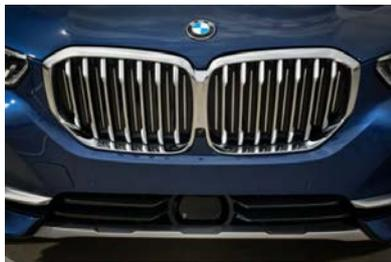
La prise d'air active se trouve dans la grille verticale et bénéficie de panneaux s'estompant automatiquement lorsque de l'air frais est nécessaire. Ce système est activé sur base de senseurs de température et de la vitesse du véhicule. Quand le moteur est en phase de montée en température, la calandre reste close afin d'optimiser l'aérodynamique. (Cette fonction est disponible depuis le lancement de la BMW Série 7).
