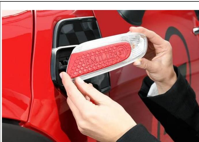
左图为 3D 打印技术应用于 MINI 个性化定制部件
