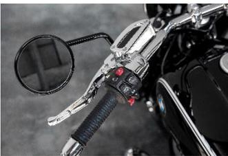
如果说设计语言的延续是传承时代经典的灵魂，安全科技则是全新 BMW R 18 思考现代骑行方式及环境后增添的必要元素。LED 头灯在自适应 LED 转向灯的配合下，为夜路骑行带来更明亮的视野。标准配备的自动稳定控制系统（ASC）、发动机牵引力矩控制系统（MSR）则通过介入动力系统来防止车身发生偏斜或轮胎打滑。同时，针对不同骑行环境，骑士们可在 Rain、Roll 和 Rock 三种驾驶模式间切换，无论是连绵起伏的山路还是潮湿泥泞的雨天，全新 BMW R 18 都能随心应对，在任何情况下都为骑士提供最大安全保护。全新 BMW R 18 证明，骑行驾趣回归原始还无法称作“传承”，唯有与时代共进才能延续经典成为未来的传奇。
