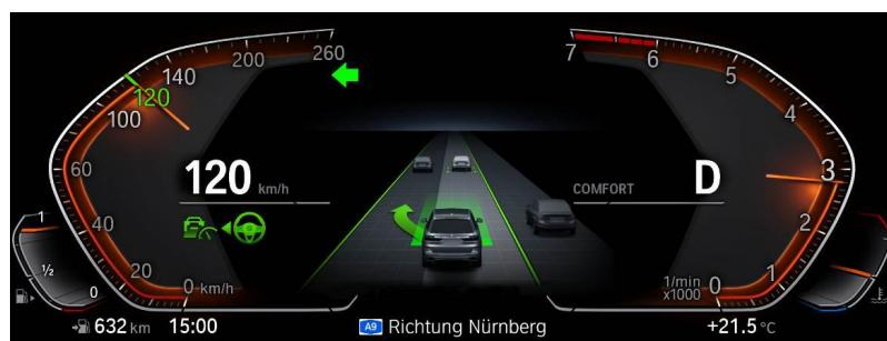
例如：交通拥堵辅助功能，在条件允许的情况下，让驾驶者可以在车道线清晰的高速和快速路上，在车速低于 60 公里/时的情况下从方向盘上放开双手，并让车辆跟随前车自动行驶。变道辅助，在高速公路或类似高速公路道路类型上行驶时，驾驶员可通过使用转向指示灯激活变道辅助功能，车辆可自动检测周围环境，在条件允许的情况下进行变道。除此之外，自动驾驶辅助系统还包括其它丰富的功能和场景。例如：辅助驾驶、前向碰撞预警及紧急制动辅助、车道纠偏辅助，能够有效提升驾驶员在驾驶过程中的舒适、便捷与安全。
