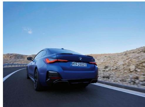
优化的智能轻量化设计与车身刚性也为全新车型的精确操控及长续航做出了贡献。车身和底盘汇总多处采用了铝质材料，整体减轻了车辆重量，提升了对路面反馈的敏锐度。热成型钢材和铝合金为车舱提供了高承载力的支撑结构，前悬支架与高压电池的壳体连接，结合后悬特殊的支柱组件，提升了车辆的车身刚度。
