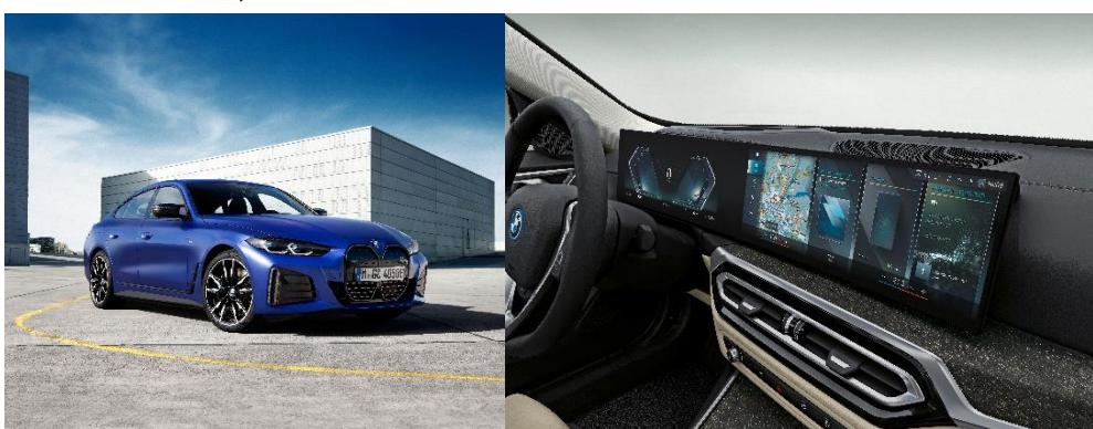
搭载第五代 eDrive 电驱技术、先进的底盘技术、智能轻量化设计以及优异的空气动力学特性，创新 BMW i4 实现了出色的续航和动态操控。BMW i4 可以提供 400 千瓦 / 544 马力的最大输出功率，峰值扭矩高达 795 牛·米，零到百公里加速
