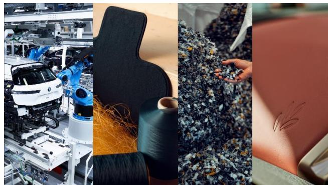
和织物均采用了大量再生材料制作，例如织物/微纤维内饰采用了 50% 的再生聚酯纤维材料，地毯地垫更是采用了 100% 再生尼龙材料；制造工艺更加环保，真皮采用橄榄叶萃取物处理，而非传统的鞣制剂，这些萃取物来自于每年在欧洲修剪橄榄树林后收集的树叶。工厂生产所需的电能全部来自当地的可再生能源——所需的绿色电力仅使用水力发电。在开发和生产中不再使用稀土材料，再生铝的比例也不断增加，以利于可持续性发展；电池阴极材料中原料钴的比例已可降至 10% 以下。高压蓄电池组中使用的锂来自于澳大利亚的硬岩矿，并且根据公司的环境和可持续性标准开采。
