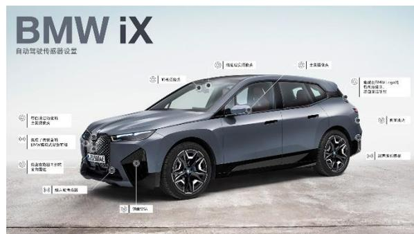
全新的驾驶辅助和泊车辅助系统为驾驶与停车提供了更高的安全性和舒适性，带来更智能便捷的驾驶乐趣。最新的转向及车道跟踪辅助系统，适用于更宽泛的交通环境。在车速低于200公里/小时该系统均可启用，并根据车道标记和前方车辆进行定位，通过转向修正为驾驶者提供支持，确保车辆始终保持在当前车道，进而保证驾乘安全。面对难以调头的狭小空间或断头路，驾驶者还可通过宝马首创的50米循迹倒车辅助功能与创新BMW iX一同脱离困境。创新技术为自动驾驶技术的可持续发展提供巨大可能。未来，宝马集团还将通过远程软件升级为创新BMW iX更新更多驾驶辅助功能，为全球用户带来更加智能的驾驶体验。
