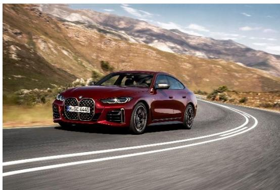
全新 BMW 4 系四门轿跑车拥有卓越的空气动力学设计，进而显著提升发动机工作效率和车辆的动态驾驶表现。智能降阻进气格栅、流线型车顶线条、经过空气动力学优化的轻合金轮毂、以及几乎完全封闭的车身底部，有效降低了空气流动的阻力，使 BMW 4 系四门轿跑车的风阻系数低至 0.26。
