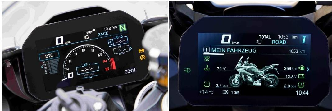
如今，BMW摩托车的用户使用界面也发生着翻天覆地的变化。众多BMW摩托车车型已配备了TFT彩色多功能仪表，仪表不仅能切换显示模式，还显示丰富的信息，如超速警告提醒、平均速度、单圈时间、倾斜角度、单圈换挡次数、单圈油门平均开度、最快圈速等，令骑者对骑行状态一目了然。并且，仪表还可实现导航、拨打电话和听歌等便捷功能，充分满足骑者日常所需。
