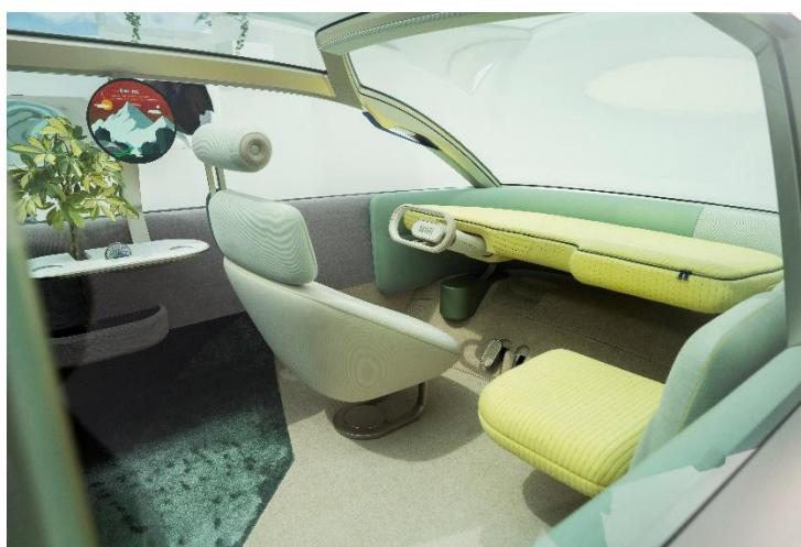
MINI VISION URBANAUT 概念车内饰和织物采用大量再生材料，摒弃了铬和皮革的使用，避免产生任何对环境有害的生产残留物。内饰主要材料是由羊毛、涤纶、天丝等回收材料制成的织物，让驾乘者感觉温馨惬意的同时也保证了柔软舒适的质地。设计师还特别注意使用单一类型材料，这些材料易于进一步回收利用，并可转化为新产品。方向盘和局部地板采用软木，天然材质令车内空间更加温馨、舒适，独具一格。总而言之，MINI VISION URBANAUT 的材料概念凸显出以可持续设计理念下车辆内饰极高的视觉和触觉质感。
