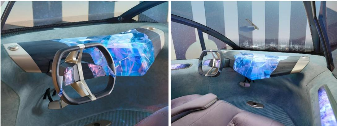
仪表板的中间部分由 3D 打印的水晶体组成，中间的装饰线如神经元一样，增加了视觉深度，令光影变得更加激动人心。它不仅在车内吸引用户视线，而且可发挥立体触控板的作用，与用户进行互动，让车辆的“思维流”变得清晰可见，无不展示出车辆的数字智能化。
