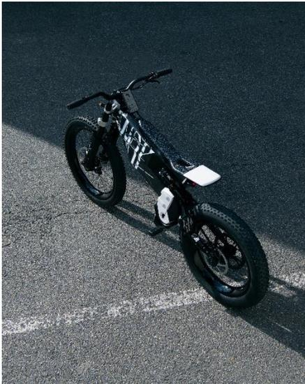
BMW Motorrad Vision AMBY 概念车同样形似自行车，但却是一辆保留了宝马摩托车探险系列车型特征的摩托车。纤细的比例、前 26 英寸轮圈、后 24 英寸轮圈，无一不展示着车辆的冒险属性。与此同时，车辆前叉还设计有保护装置，让车头看起来更显庞大、有力。
