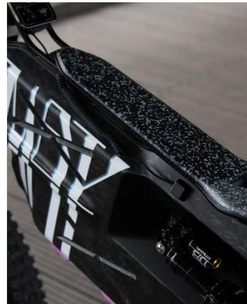
两款概念车还在车身中应用了与 BMW i 循环概念车相同的再利用材料。BMW i Vision AMBY 概念车的部分车把构件，以及两款车电池外侧的覆盖件和鞍座均采用了再利用塑料。当产品生命周期结束时，这类材料更易于再次回收并进入宝马集团的材料循环体系中。
