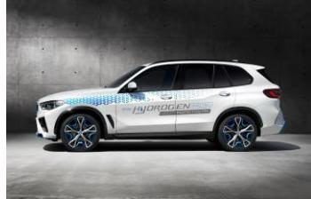
针对这一特殊驱动系统，BMW iX5 Hydrogen Protection VR6 概念车运用了整体安全概念，将底部特殊防护技术与氢燃料电池驱动系统相结合，充分保证驱动系统的安全。车辆底部经过专门设计，以防止手榴弹在车底爆炸对车辆下部产生损坏。通过底部特殊保护装置对氢气罐及其阀门系统进行密封。同时，该保护装置进行了轻量化处理，尽可能让车辆拥有最大的离地间隙，保证车辆的良好通过性。
