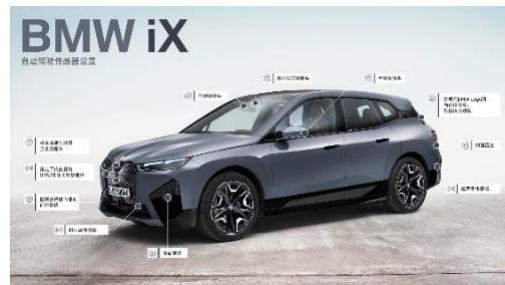
创新 BMW iX 配备了含紧急制动辅助功能的前向碰撞预警系统，当检测到行人、骑车者或车辆时，系统可以发出警示提醒驾驶者减速，或使车辆自动刹车。此外，自动紧急制动系统还可在转弯情况下做出反应，最大限度地减少车辆过弯时可能对行人造成的伤害以及左转时与迎面而来的车辆相撞的风险。另外，创新 BMW iX 还标配了注意力保持辅助、车道偏离警告和限速识别等安全辅助功能，使车辆分别在“乘员状态监控”、“车道辅助系统”和“速度辅助系统”等测试分项中获得较高评分。
