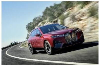
创新 BMW iX 搭载**第五代 BMW eDrive 电驱系统**，xDrive 50 车型 CLTC 标准下续航里程最高可达 665 公里，双电机释放最大输出功率 385 千瓦，峰值扭矩 765 牛米，零至百公里加速 4.6 秒，百公里能耗低至 18.5 千瓦·时。新车配备直流快速充电和家用充电两个充电接口，直流充电可以接受最大
