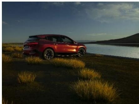
在车辆操控性能和驾乘质感方面，创新BMW iX为豪华大型电动SUV细分市场树立了全新的标杆。智能轻量化车身与空气动力学设计功不可没。碳纤维增强复合材料被广泛应用在车身框架，车门边框、尾门等位置都可看到这种高科技的车身材料。而得益于水滴型车尾、隐藏式门把手、纤细的外后视镜等空气动力学设计下，创新BMW iX风阻系数仅为0.25，几乎媲美跑车。
