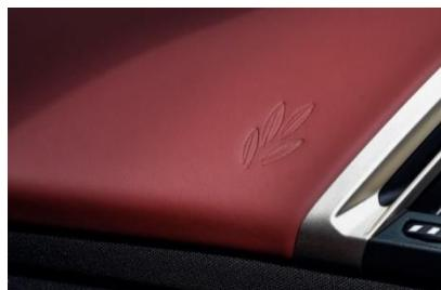
创新 BMW iX 中控台上的控制面板采用可持续生产的 FSC 认证木材；内饰和织物均采用了大量再生材料制作，例如织物/微纤维内饰采用了 50% 的再生聚酯纤维材料，地毯地垫更是采用了 100% 再生尼龙材料；制造工艺更加环保，真皮采用橄
