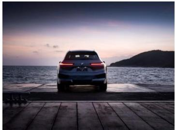
空气动力学设计方面，在水滴型车尾、隐藏式门把手、纤细的外后视镜等众多设计的共同作用下，**创新BMW iX风阻系数仅为0.25**，几乎媲美跑车。车身各处的空气动力学部件整体提升了65公里以上的续航里程。其中，全新空气动力学轮毂增添了优雅魅力的同时，重量减轻15%，并优化了空气动力学特性，使续航里程提升15公里左右。
