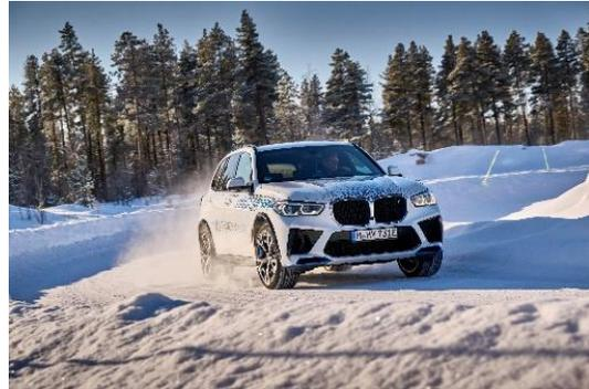
冬测区域内的结冰和积雪路面为全面测试 BMW iX5 Hydrogen 氢燃料电池车提供了绝佳环境。车辆驱动系统、能量储存系统和控制系统均通过了极寒耐力测试。转向系统、弹簧、减震器、底盘控制系统，以及制动片摩擦的相互作用和减速时的能量回收，也在极端气候条件下进行了集中测试和精准调校。
