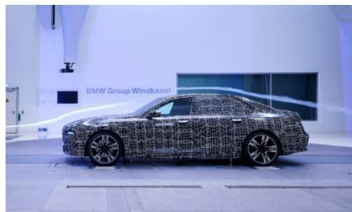
而在声学风洞实验中，BMW i7的气动声学表现得到了进一步的完善。BMW i7简约流畅的车身表面、嵌入式门把手、经过空气动力学优化的后视镜和几乎完
