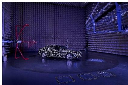
此外，研发和测试工程师还对电磁兼容性(EMC)进行了详细分析和精确优化。工程师将BMW i7原型车暴露于强大的电磁场中，以测试其电气系统对电磁干扰的敏感度。测试工程师可通过实时数据分析测试结果，确保车辆悬架控制系统和辅助系统的可靠运行，以及在线数据、电话、广播、视频和导航信号的无干扰接收。
