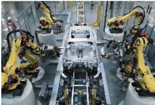
空间进行规划和模拟，既缩短了规划时间，又实现了远程维护和实时协作。行业领先的“智能综合能源管理系统”更是通过监测、分析能源消耗情况，不断有针对性的在全新 BMW i3 生产过程中优化水资源及其他能源的使用效率与循环能力。除此之外，全新 BMW i3 还应用多种创新生产设备进一步降低能源消耗，在冲压过程中，通过车间主动控制柜能够有效提高能效和避免冷却水使用，减少约 5% 的用电量。在全新 BMW i3 车身焊接时，通过最新控制标准，实现利用电烘干炉和 BMW 第四代电伺服焊枪进一步降低能耗，全面实现了可持续生产。而在涂装环节，通过热量回收和废气过滤工艺，有效实现室内空气的循环利用。同时反渗透电泳涂层的应用能够在降低净水用量的同时减少危险废弃物的排放。
