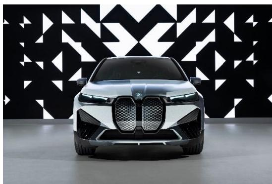
**BMW iX Flow** 车身上的一层特殊薄膜，蕴藏着宝马创新的“科技魔法”——电子墨水（*E Ink*）技术。电子墨水的双颜料电子系统由数百万个透明微胶囊组成，每个微胶囊直径仅为一根头发的厚度。微胶囊中则含有带负电的白色颜料，以及带正电的黑色颜料。通过控制微胶囊两侧的电极，可使所需颜色出现在车身表面上，从而实现车身变色。
