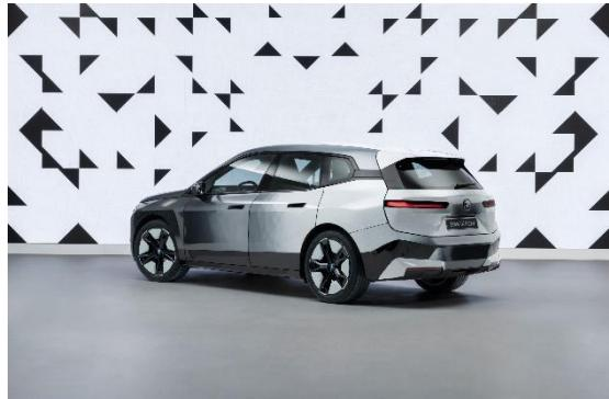
此外，在功能性方面，车身颜色的变换有利于降低能耗，助力可持续发展目标的实现。可变换的车身颜色有利于提升车内舒适性，降低电气系统所需能量。例如，相比黑色，白色表面能够反射更多阳光，如若将车身颜色变为浅色，可相应减少因外部强烈阳光照射和高温对车辆内部的影响，防止中控台、仪表板等内饰过热。而在温度较低的情况下，将车身变为深色可有助于从阳光吸收更多热量，减少空调加热所需能耗，可有效增加电动续航里程。值得一提的是，“电子墨水”技术本身非常节能，只有在短暂的变色过程中消耗少量电能，维持颜色状态则完全不产生能耗。
