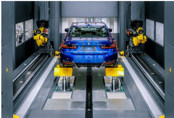
几何光学测量系统（GOM）对整车进行完整的扫描
