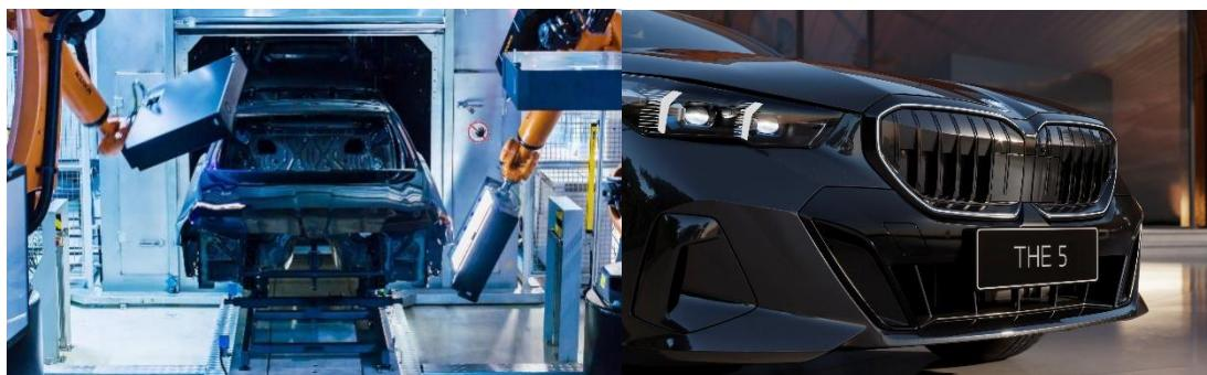
“宝石青”车漆色其实是一种带有独特光泽的黑色，为了保证最佳的漆面效果，智能漆面检测系统就像“鹰眼”捕猎一样敏锐，机器人对车身 360 度扫描，每秒拍摄 3,200 张照片，0.01 毫米的细微瑕疵也逃不掉。每台车在交付前都会被拍摄超过 10 万张照片，系统能分析光暗变化，及时处理问题。在非生产时间，AI 还能自动复盘当天的数据，为后续生产做好准备。
