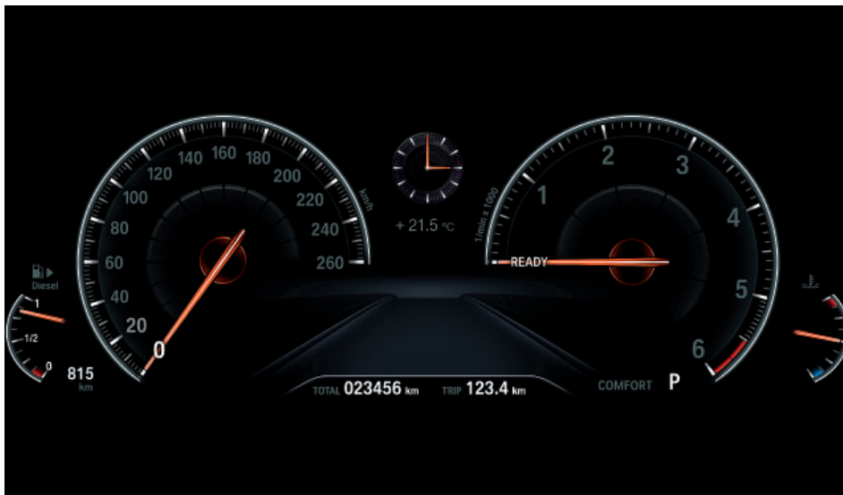
Multifunkční přístrojový panel
