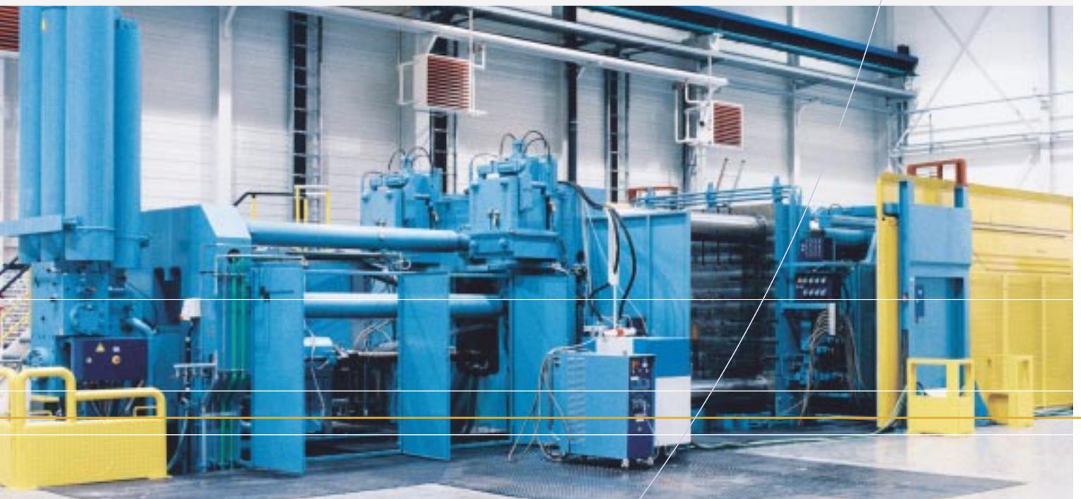
BMW Group Werk Landshut: LITZ Leichtmetall Druckgussmaschine
