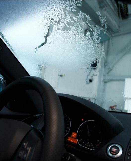
Versuch Enteisung mit dem Ziel: bei minus 20 °C in max. 25 Minuten Abtauung von 95 % der Sichtfläche
