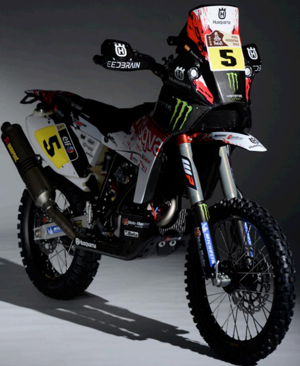
Wassergekühlter Einzylinder-Viertaktmotor, zwei obenliegende Nockenwellen, vier Ventile, Trockensumpfschmierung mit Ölkühler, elektronische Saugrohreinspritzung/digitale Motorsteuerung
