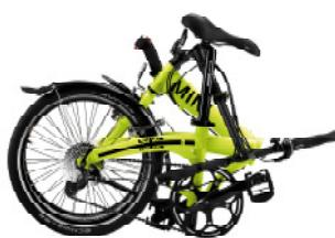
In Sekundenschnelle lässt sich das Rad an Mittel- und Lenkerstange zusammenfalten. Zusätzlich lassen sich die Pedale einklappen und der Sattel absenken. So ist der MINI auf zwei Rädern mühelos zu tragen und platzsparend zu verstauen.
