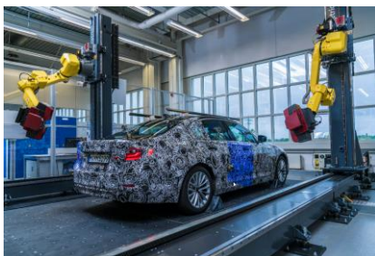
Bild 01: Die Vorbereitungen auf den Anlauf des neuen BMW 5ers laufen – auch wenn er sich bis dato nur in Tarnung zeigt. Hier in einer vollautomatisierten, optischen Messzelle.
