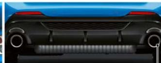
Zweibordige Abgasanlage mit  $\varnothing$  90mm (ab 4-Zylinder), BMW M135i xDrive  $\varnothing$  100mm schräg angeschnitten.
