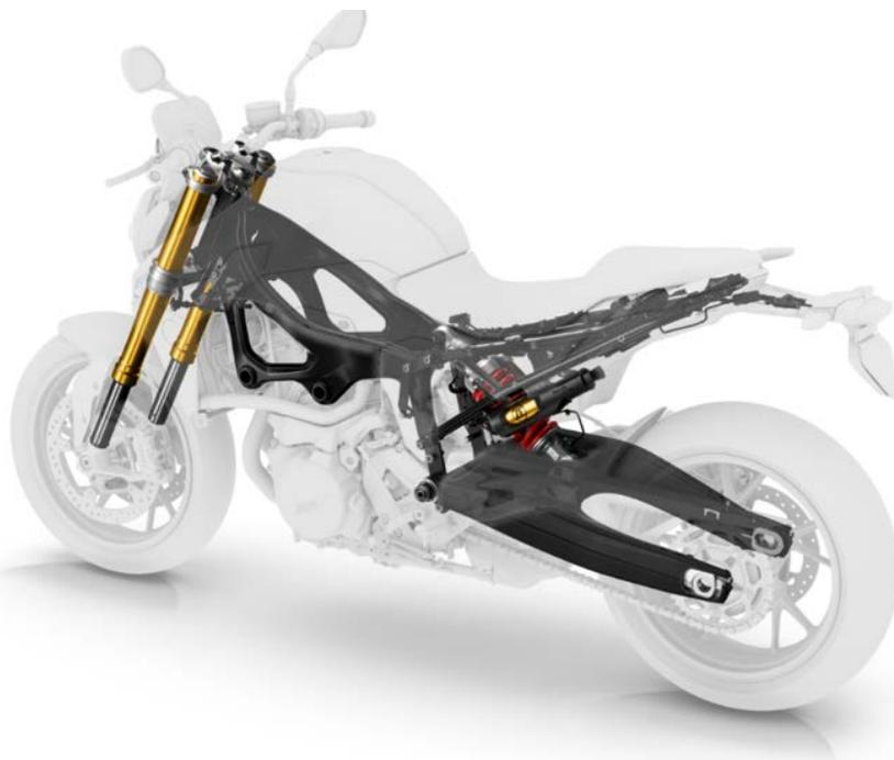
**„Durch Anpassungen von Lenkkopfwinkel, Offset und Nachlauf konnten wir für die Straßenmodelle eine besonders sportliche Fahrwerksauslegung realisieren. Die optimale Gestaltung der jeweiligen Ergonomiedreiecke ermöglicht eine starke segmentspezifische Unterscheidung bei gleichzeitig großen Individualisierungsmöglichkeiten.“**
