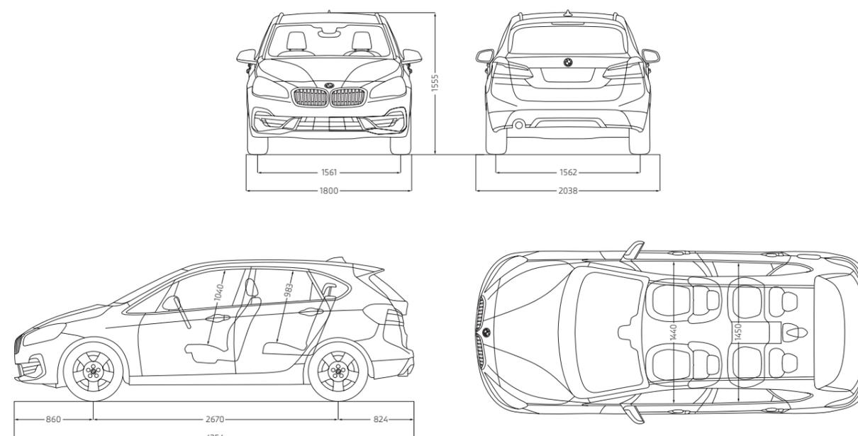
Alle Maßangaben der technischen Zeichnung in Millimeter. Werte in [ ] gelten für Fahrzeuge mit Steptronic Getriebe
