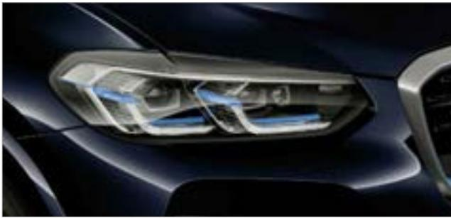
□ Das adaptive BMW Laserlicht leuchtet im Laser-Fernlichtmodus mit bis zu 650 m nahezu doppelt so weit wie herkömmliche Scheinwerfer. Durch die bessere Sicht im Dunkeln wird so die Sicherheit deutlich erhöht. Blaue Akzente und der Schriftzug „BMW Laser“ im Scheinwerfer unterstreichen zudem den technologischen Anspruch und die Sportlichkeit des Fahrzeugs.
