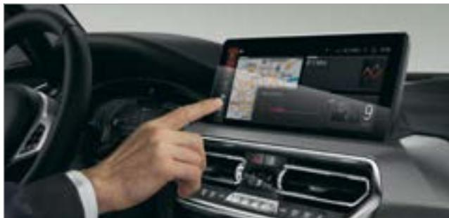
■ Mit der BMW Gestiksteuerung lassen sich festgelegte Funktionen durch bestimmte Handbewegungen bedienen. Für bestimmte Bedienvorgänge erkennt das System z. B. die Gesten „Wischen“ oder „Zeigen“, die u. a. das Annehmen oder Ablehnen eines eingehenden Anrufs bewirken, oder das Regeln der Lautstärke durch Drehbewegungen mit dem Zeigefinger.
