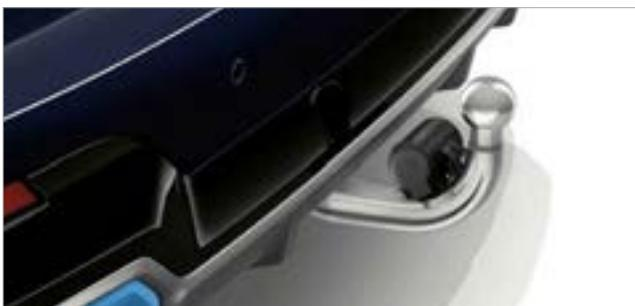
□ Die Anhängerkupplung mit elektrisch schwenkbarem Kugelkopf ist für Anhängelasten bis zu 750 kg zugelassen. Zur Stabilisierung bremsst die Anhänger-Stabilitätskontrolle bei einem Pendeln des Anhängers das Zugfahrzeug automatisch ab. Unter die Heckschürze geklappt ist der elektrisch schwenkbare Kugelkopf nicht sichtbar.
