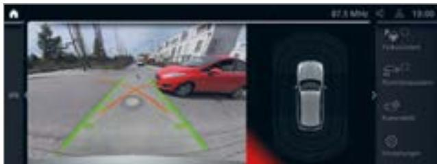
■ Der Parking Assistant Plus<sup>2</sup> erleichtert das Parken und Rangieren des Fahrzeugs. Er umfasst u. a. das Surround-View-System mit Top View, Panorama View und Remote 3D View sowie eine seitliche Einparkhilfe, die Notbremsfunktion Active Park Distance Control, den Parkassistenten mit Längs- und Querführung und den Rückfahrassistenten.
