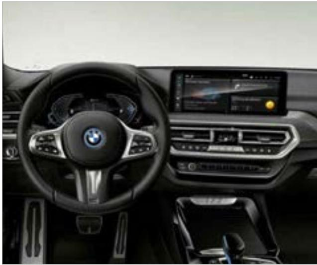
■ Das BMW Live Cockpit Professional mit Navigationsfunktion umfasst einen hochwertigen Anzeigenverbund. Dieser besteht aus einem hochauflösenden, per Touch bedienbaren 12,3" großen Control Display und einem volldigitalen 12,3" großen Instrumentendisplay. Das BMW Operating System 7 kann u. a. über den BMW Intelligent Personal Assistant bedient werden.
