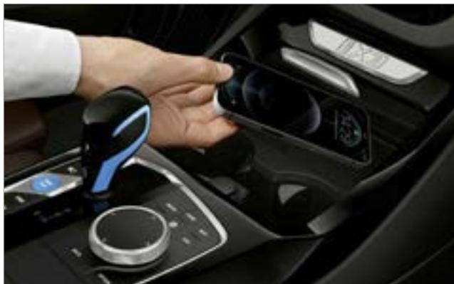
■ Die Telefonie mit Wireless Charging umfasst eine Ladeschale mit drahtloser Ladefunktion. Eine Dachantennenanbindung sorgt für besseren Mobilfunkempfang. Per Bluetooth lassen sich zwei Mobiltelefone und ein Audioplayer zugleich verbinden. Dazu kommt eine WLAN Hotspot Vorbereitung.
