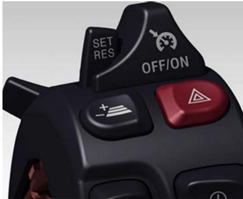
Die serienmäßige Dynamic Cruise Control (DCC) regelt automatisch die vom Fahrer eingestellte Fahrgeschwindigkeit. Dynamisch bedeutet, dass auch bei Bergabfahrten die vorgewählte Geschwindigkeit konstant gehalten wird. Falls die Bremswirkung des Motors hierfür nicht ausreichend ist, so wird
