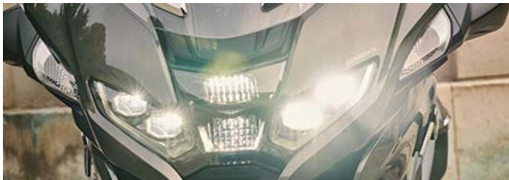
Noch einen Schritt weiter geht der neu entwickelte Scheinwerfer der R 1250 RT mit der Schwenkfunktion als Sonderausstattung „Adaptives Kurvenlicht“. Hierbei wird das Abblendlicht des serienmäßigen LED-Scheinwerfers abhängig von der Schräglage in die Kurve hineingedreht. Auf diese Weise werden Kurven nahezu
