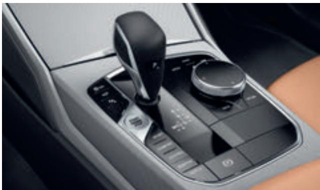
■ Das 8-Gang Steptronic Getriebe ermöglicht einen besonders hohen Schalt- und Fahrkomfort durch eng gestufte Gänge und minimierte Drehzahlsprünge. Dadurch wird höchster Komfort mit beeindruckender Dynamik und einem geringen Kraftstoffverbrauch kombiniert.
