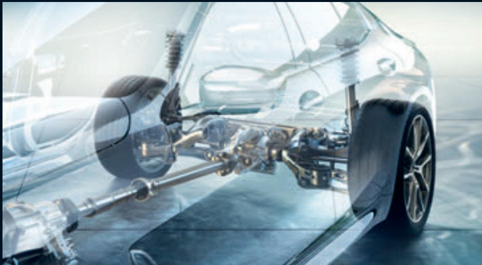
■ Das M Sportdifferenzial<sup>1</sup> optimiert die Traktion und Fahrstabilität beim Spurwechsel und Herausbeschleunigen aus Kurven, bei hoher Kurvengeschwindigkeit sowie unterschiedlicher Straßenbeschaffenheit. Die Traktionsoptimierung erfolgt über eine elektronisch gesteuerte Lamellensperre zur Reduktion der Drehzahlunterschiede zwischen den Hinterrädern.
