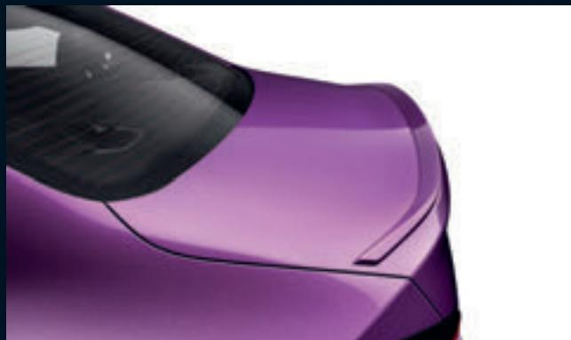
□ Der M Heckspoiler<sup>1</sup> betont die sportliche Silhouette des Fahrzeugs und reduziert den unerwünschten Auftrieb.
