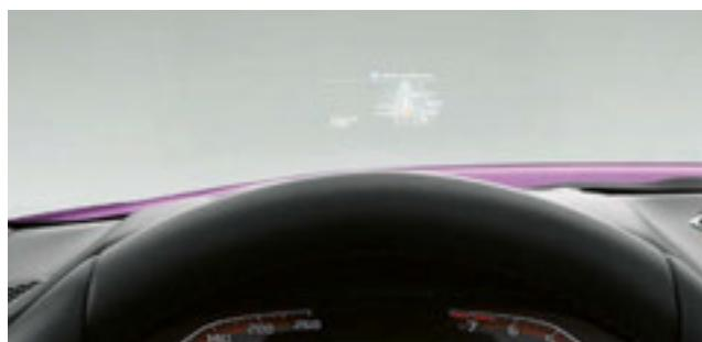
□ Das große vollfarbige BMW Head-Up Display<sup>1</sup> blendet per optischer Projektion für die Fahrt relevante Daten in Ihr Sichtfeld ein und steigert damit die Konzentration auf das Fahrgeschehen. So werden hier ausstattungsabhängig die aktuelle Geschwindigkeit, Navigationshinweise, die Speed Limit Info inkl. Überholverbotsanzeige und Telefon- und Entertainmentlisten angezeigt.
