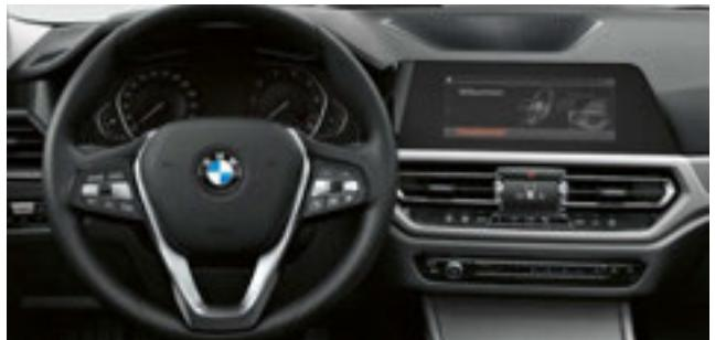
■ Das schwarze Sport-Lederlenkrad mit vier Speichen verfügt über eine Dekorblende in Perlglanz Chrom. Ein dicker Lenkradkranz und ausgeformte Daumenauflagen bieten eine besonders angenehme und griffige Haptik.
