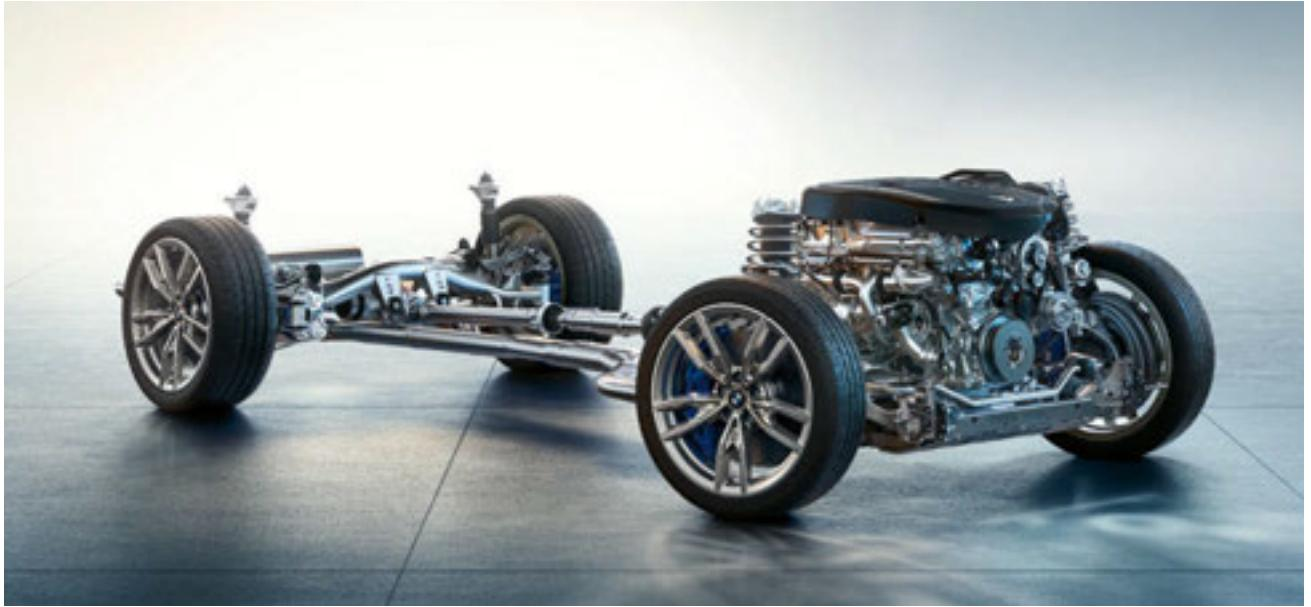
□ Das M Sportfahrwerk<sup>1</sup> zeichnet sich durch eine sportlichere Fahrwerksabstimmung mit strafferer Dämpfereinstellung aus. Zusätzlich verfügt es über eine moderat erhöhte Federrate und härtere Stabilisatoren. Im Zusammenspiel ergibt sich daraus eine nochmals direktere Fahrwerksauslegung, die eine betont sportliche Fahrweise ermöglicht.
