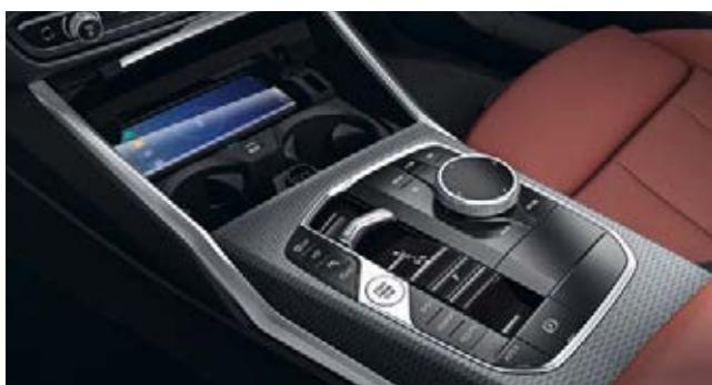
□ Die Wireless Charging Ablage lädt Ihr Smartphone komfortabel ohne Kabel mit bis zu 15W Leistung. Eine integrierte Kühlung schützt vor Überhitzung.
