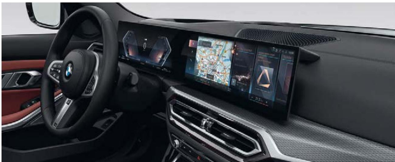
□ Das BMW Live Cockpit Professional mit großflächigem Curved Display erweitert das BMW Live Cockpit Plus um ein vollfarbiges Head-Up Display. Dieses projiziert Fahrinformationen wie die Geschwindigkeit oder Navigationshinweise direkt ins Blickfeld – für einen besseren Überblick und mehr Sicherheit.
