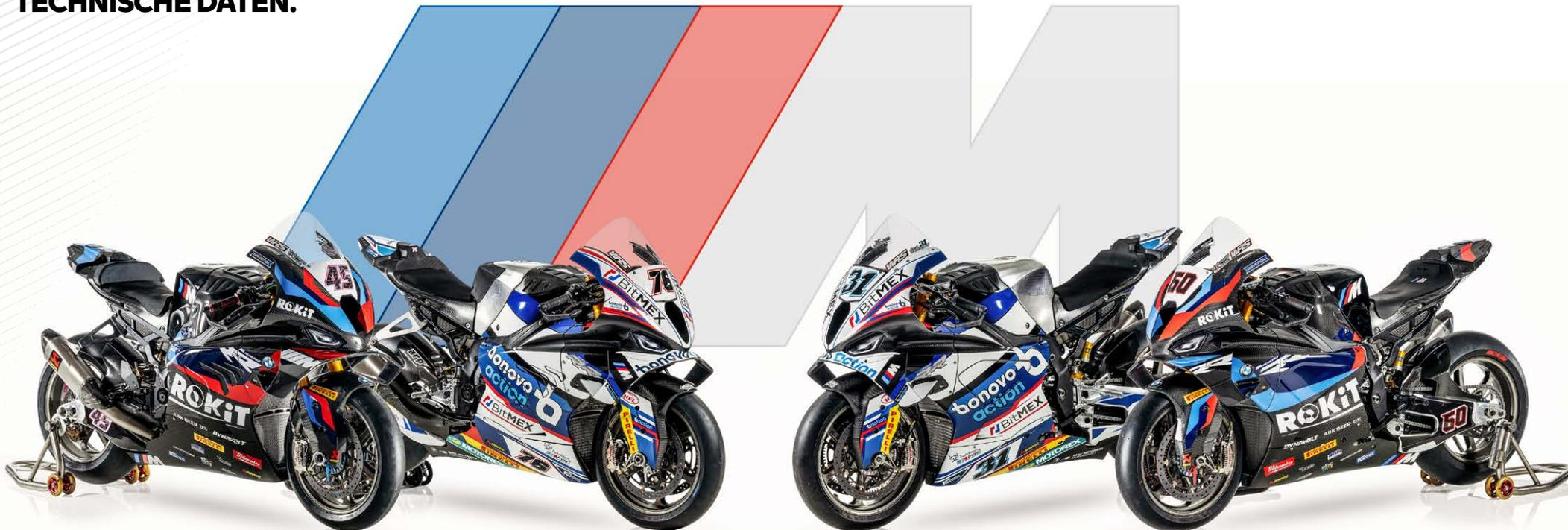
**Hubraum/Motor:** 999 ccm, Viertakt-Vierzylinder-Motor mit vier Titanventilen pro Zylinder und variabler Einlass-Nockenwellensteuerung BMW ShiftCam, flüssigkeitsgekühlt, Titan-Pleuel, 2-Ring-Kolben
