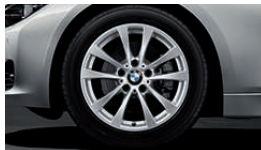
□ Jantes en alliage léger 17" (43 cm) style 395 à rayons en V avec monte pneumatique mixte, 7,5 J x 17 à l'avant, pneumatiques 225/50 R 17, 8,5 J x 17 à l'arrière, pneumatiques 255/45 R 17.
