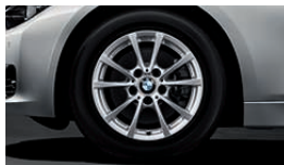
■ Jantes en alliage léger 16" (41 cm) style 390 à rayons en V, 7 J x 16, pneumatiques 205/60 R 16 (de série sur BMW 320d).
