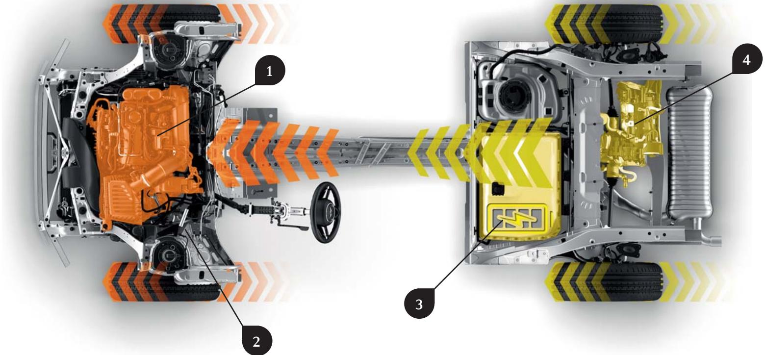
Le système hybride rechargeable gère automatiquement l'interaction entre le moteur thermique **1** et électrique **4**. Couplé à la boîte de vitesses automatique à 6 rapports **2**, le moteur essence de 136 ch entraîne les roues avant. Le moteur électrique de 88 ch entraîne les roues arrière afin de procurer une transmission intégrale e-ALL4. La batterie haute tension **3**, située sous la banquette arrière, stocke l'énergie nécessaire au moteur électrique.
