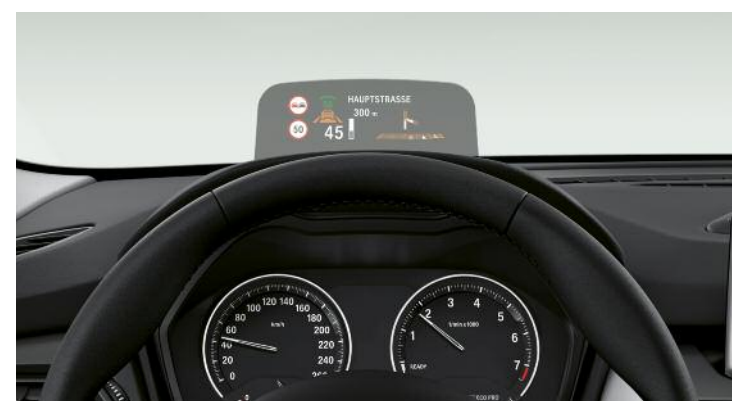
L'Affichage Tête Haute HUD couleur affiche, par le biais d'un système de projection optique, toutes les informations importantes pour la conduite dans le champ de vision du conducteur via une lame en plexiglas.
