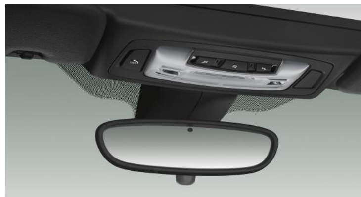
Rétroviseur intérieur électrochrome et indicateur visuel d'activation de l'alarme.
