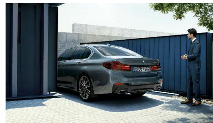
Pour les emplacements de parking étroits où la sortie/l'accès au véhicules est difficile pour le conducteur et les passagers, le véhicule peut de manière automatique être garé (en marche avant) et sortie d'un emplacement en bataille en activant la fonction "Remote Control Parking" sur la BMW Display Key. Le conducteur étant à l'extérieur du véhicule pendant la manœuvre.
