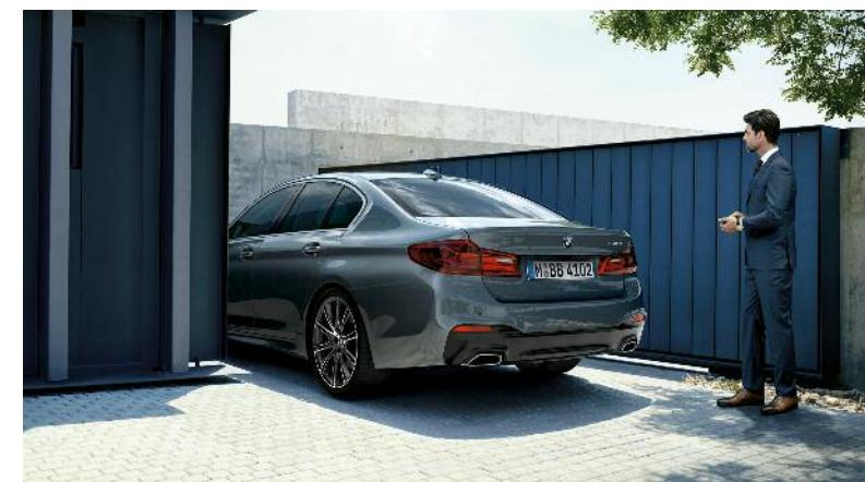
Pour les emplacements de parking étroits où la sortie/l'accès au véhicule est difficile pour le conducteur et les passagers, le véhicule peut de manière automatique être garé (en marche avant) et sortie d'un emplacement en bataille en activant la fonction "Remote Control Parking" sur la BMW Display Key. Le conducteur étant à l'extérieur du véhicule pendant la manœuvre. (Visuel non contractuel)
