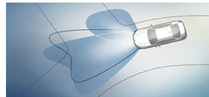
Les projecteurs directionnels à LED avec répartition variable de la lumière en ville et sur autoroute et feux de route permanents anti-éblouissement "BMW Selective Beam" assurent un éclairage optimal de la chaussée. L'éclairage d'intersection compris dans l'équipement s'active automatiquement, même à l'arrêt, dès que le clignotant est actionné ou à partir d'un certain angle de rotation du volant et ce jusqu'à une vitesse de 35 km/h.
