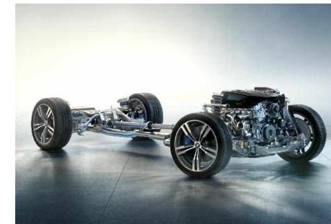
Système de régulation des trains roulants associant un grand confort de conduite à d'excellentes qualités dynamiques. Il est basé sur la direction ActiveDrive à 4 roues directrices et des stabilisateurs actifs qui assurent une régulation électromécanique en continu et minimisent ainsi l'inclinaison de la carrosserie.
