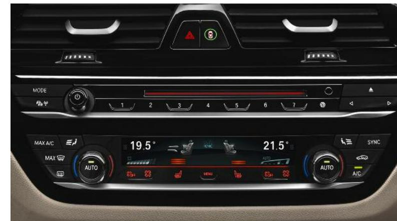
Le chauffage des sièges chauffe la surface d'assise et le dossier des sièges avant et arrière latéraux, la température étant réglable sur trois niveaux et séparément pour chaque siège. Avant même que le moteur n'atteigne sa température de service, il suffit d'une pression sur un bouton pour que les sièges chauffants diffusent rapidement, et ce quelle que soit la température extérieure, une chaleur agréable.
