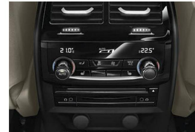
Inclut des fonctionnalités étendues en plus des fonctionnalités de la climatisation automatique 2 zones ainsi que deux aérateurs sur les montants centraux. Par ailleurs, les passagers arrière bénéficient d'un réglage individuel via une commande séparée avec affichage.
