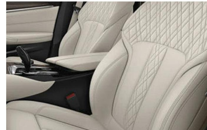
Les sièges Advanced Comfort pour conducteur et passager avant, avec appuis-tête actifs, sont dotés de nombreux réglages électriques. Il est ainsi possible de régler individuellement la partie supérieure et la largeur du dossier, la longueur d'assise et la hauteur des appuis-tête. L'équipement comprend en outre un appui lombaire ajustable et une fonction mémoires pour le conducteur et le passager avant.
