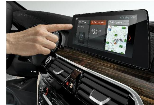
Grâce à la commande gestuelle BMW, il est possible de piloter certaines fonctions grâce à des mouvements précis de la main. Pour certaines commandes, le système reconnaît ainsi les gestes « balayer » ou « montrer », qui permettent notamment d'accepter ou de rejeter un appel entrant, ou encore de régler le volume sonore. Pour régler le volume sonore, il suffit d'effectuer un mouvement rotatif avec l'index.
