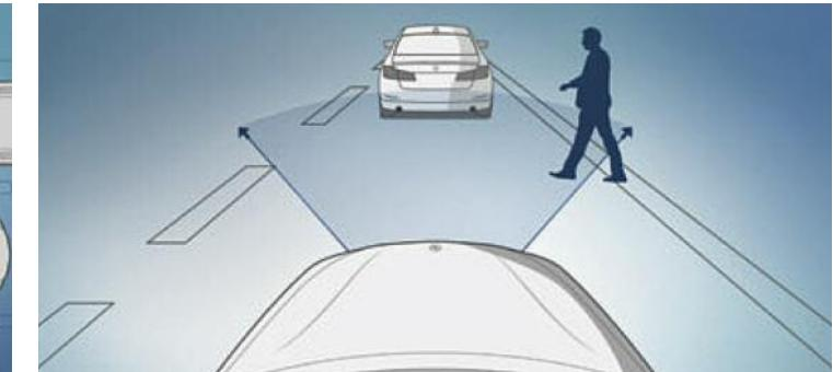
La Protection active des piétons et Système anti-collision à basse vitesse assiste le conducteur activement en évitant les collisions avec les piétons. Jusqu'à une vitesse de 60 km/h, il avertit le conducteur tout en pré-conditionnant les freins pour une réactivité maximale. En cas d'urgence, le système empêche une collision ou assure une nette diminution de la vitesse de collision.
