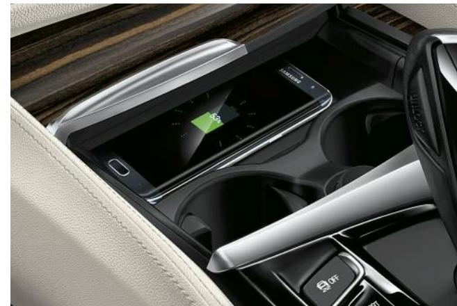
Comprend une plaque de recharge sans fil avec ports USB supplémentaires. La connexion à l'antenne de toit permet une réception mobile optimale. Deux téléphones portables et un lecteur audio peuvent être connectés en même temps via Bluetooth. À cela s'ajoutent une fonction de bureautique Bluetooth et une préparation pour hotspot Wi-Fi.
