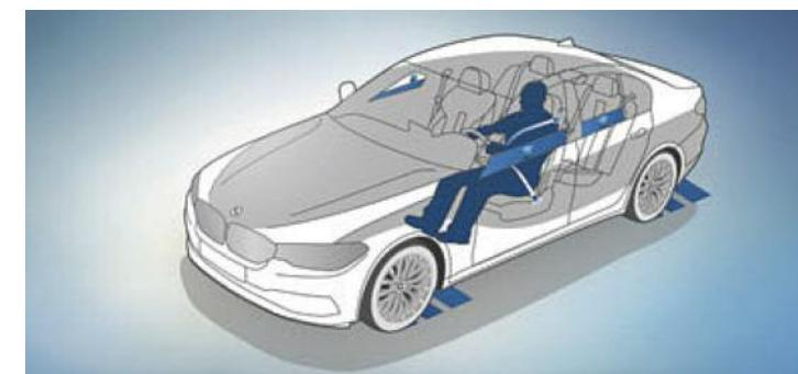
La Protection active des occupants est un système de sécurité préventif signé BMW ConnectedDrive. Elle prévient le conducteur en cas de fatigue ; dans les situations critiques, les ceintures de sécurité sont prétensionnées, le dossier des sièges à réglages électriques est redressé, les vitres et le toit ouvrant sont fermés. Après un accident, le système freine automatiquement la voiture jusqu'à l'arrêt.
