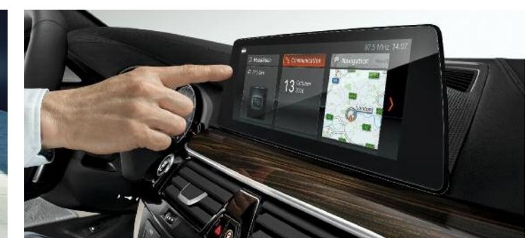
Grâce à la commande gestuelle BMW, il est possible de piloter certaines fonctions grâce à des mouvements précis de la main. Pour certaines commandes, le système reconnaît ainsi les gestes "balayer" ou "montrer", qui permettent notamment d'accepter ou de rejeter un appel entrant, ou encore de régler le volume sonore. Pour régler le volume sonore, il suffit d'effectuer un mouvement rotatif avec l'index.
