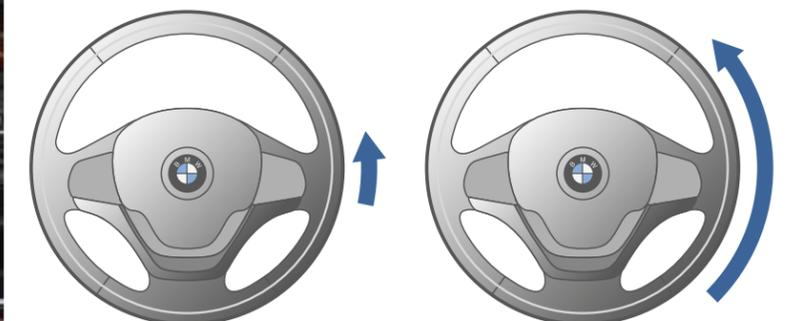
La direction DirectDrive à démultiplication variable réduit l'effort et l'angle de braquage nécessaire au volant pour plus de confort au quotidien.
