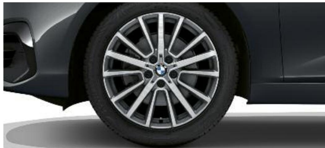
Jantes en alliage léger 18" (46 cm) style 512 à rayons en étoile, Orbit Grey, pôle; 8J x 18 / pneumatiques 225/45 R18 RSC permettant le roulage à plat.
